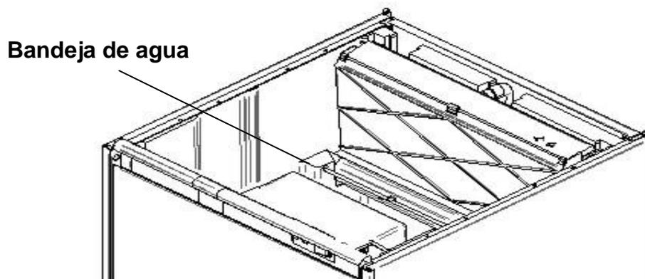
7. Poner el interruptor de limpieza (desactiva el compresor) (ver figura inferior) en la posición 0, y activar la máquina para que funcione la bomba. Dejar la solución circular 30-40 minutos y entonces apagar la máquina.
