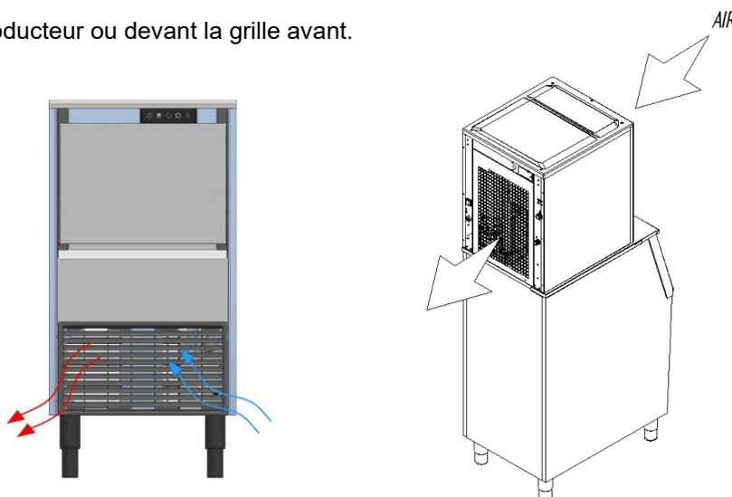
**Pour les machines condensées par air (Image III), si l'entrée d'air avant est insuffisante, la sortie est totalement ou partiellement obstruée, ou si en raison de son emplacement elle va recevoir de l'air chaud d'un autre appareil, nous conseillons fortement, en cas de ne pas pouvoir changer l'emplacement de la machine, d'INSTALLER UNE MACHINE CONDENSÉE PAR EAU.**
